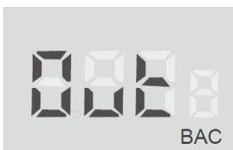
Pokud do 15 sekund nedojde k vyfouknutí vzorku dechu, LCD displej zobrazí nápis "Out". Opět stiskněte **START**, započne nové odpočítávání a test se opakuje.
