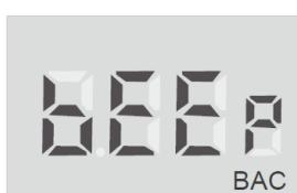
**Zvukové upozornění:** Defaultně tester nevydává žádný zvukový signál o získání specifické hodnoty. Chcete-li zvukový signál, stiskněte **START** po dosažení zvolené hodnoty.
