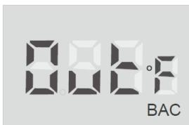
Pokud zapnete tester mimo rozsah pracovní teploty (0-40 °C), displej zobrazí nápis "Out°F" a testování nelze provést.
