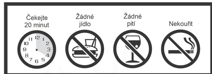
Testované osoby by měly počkat 20 minut po jídle, pití nebo kouření, než začnou foukat do BACtrack testeru. Nepodaří-li se počkat 20 minut, může dojít k nepřesným výsledkům testů a poškození čidla.
