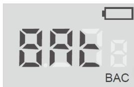
Jakmile se na displeji zobrazí ikona prázdné baterie, vložte do přístroje dvě nové tužkové alkalické baterie typu AA.
