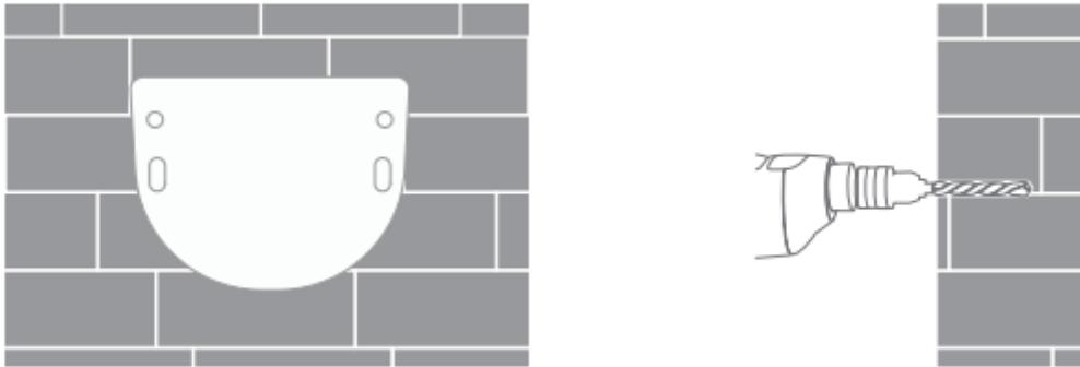
2. Setzen Sie zwei Kunststoff-Spreizmuttern in die Wand ein. Setzen Sie die Grundplatte auf die Wand. Sichern Sie die Grundplatte, indem Sie die Schrauben in die Spreizmuttern einführen.
