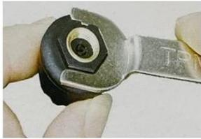
Verwenden Sie den Schlüssel, um die obere Abdeckung zu öffnen.
