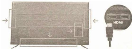
2. Verbinden Sie den Fernseher und das Empfangsgerät über ein HDMI-Kabel. Verbinden Sie anschließend den Empfänger mit dem USB-Datenkabel. Zum Schluss drücken Sie den Schalter am Empfänger, um ihn einzuschalten.
