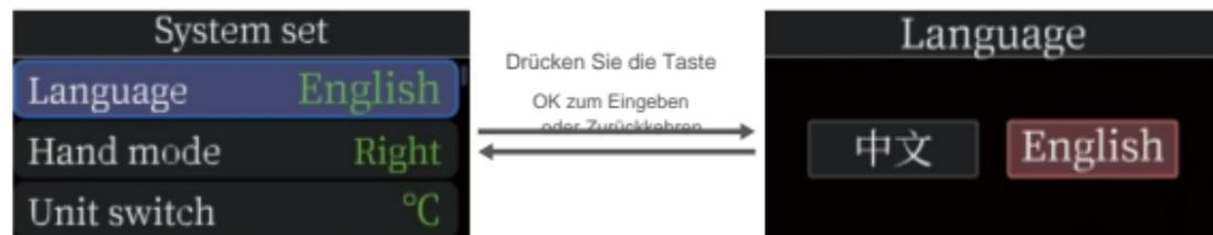
Durch Drücken der rechten Taste oder einer Inaktivitätsperiode von mehr als 1 Minute wird der Setup-Modus beendet.
