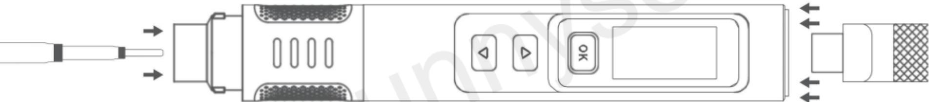
•Stecken Sie nach dem Anschluss des Netzkabels des entsprechenden Modells die offiziell kompatible Lötspitze in •.
