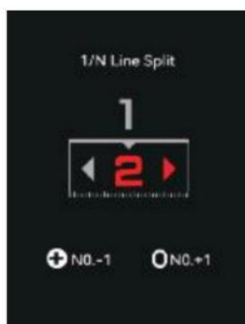
Nachdem Sie den 1/N-Wert eingestellt haben, drücken Sie die Messtaste oder ziehen Sie am Messband, um die Messung zu bestätigen und zu starten.
