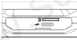
Das Gerät ist mit TF ausgestattet. Kartenanschluss (eingesteckt). Drücken Sie leicht auf die Karte und entfernen Sie sie.
