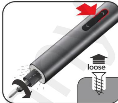
3. Drücken Sie **den Knopf**, lösen Sie die Schraube und schalten Sie gleichzeitig das Licht ein
