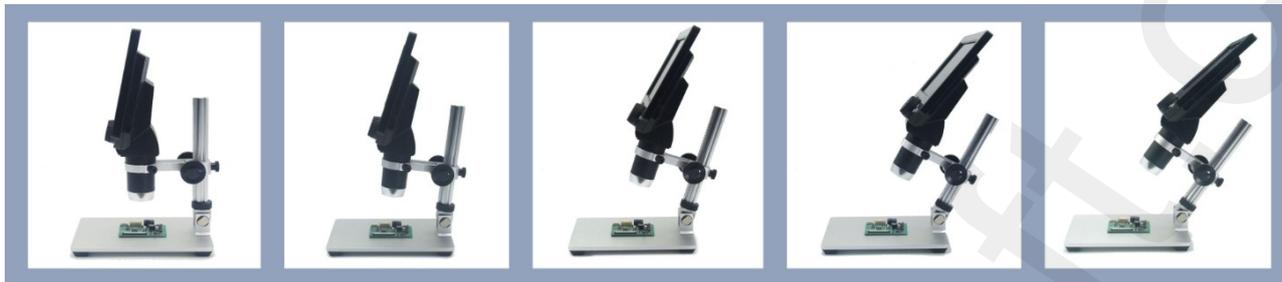
Bei maximaler Vergrößerung beträgt der geringste Abstand zwischen der Instrumentenlinse und dem Objekt etwa 10 mm. Umgekehrt gilt: Je weiter die Linse vom Objekt entfernt ist, desto geringer ist die Vergrößerung.
