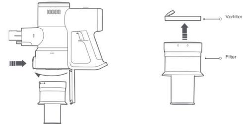
2. Drehen Sie den Endfilter wie gezeigt und entfernen Sie ihn.
