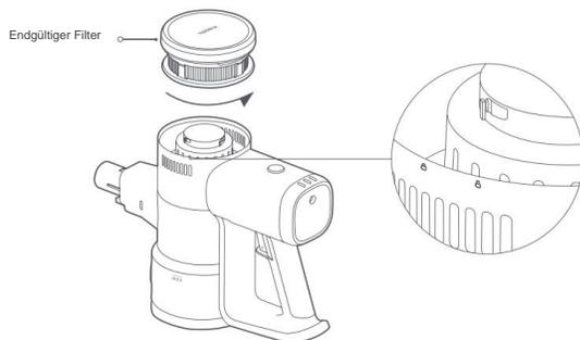
3. Spülen Sie den Filter, den Vorfilter und den Endfilter unter fließendem Wasser aus, bis sie sauber sind, und lassen Sie sie dann mindestens 24 Stunden lang vollständig trocknen.
