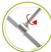
Lazítsa meg (forgatja az óramutató járásával ellentétes irányba)
