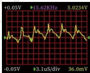
Nagy fordulatszámú feszültségingadozás (váltakozó kapcsolás)
