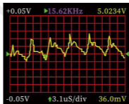
Vysokorychlostní zvlnění napětí (střídavá vazba)
