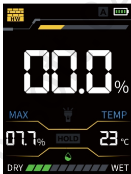
Režim zkoušky betonové stěny
