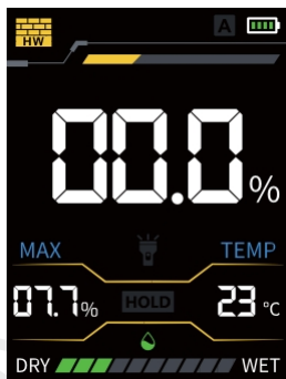
Beton fal vizsgálati mód
