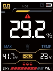
Hohe Luftfeuchtigkeit (nass)
