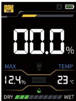
Tryb testowy ściany gipsowej
