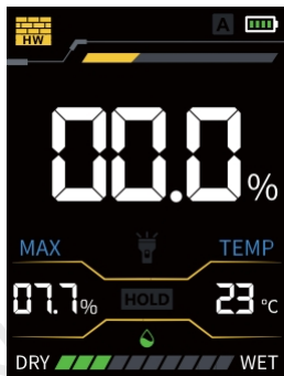
Режим на изпитване на бетонна стена
