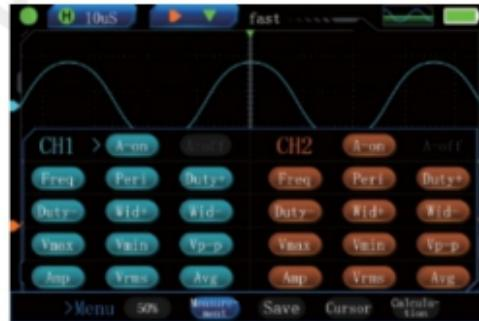
**Spremi:** Kliknite gumb Spremi za spremanje stranice s mjeranjem osciloskopa u mapu s datotekama snimki zaslona na USB flash pogonu instrumenta kao BMP sliku. Naziv slike prikazuje se prilikom spremanja.
