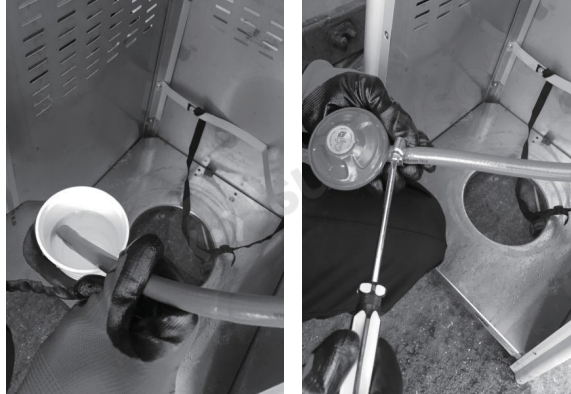
Richtiger Anschluss von Schlauch und Regler an die Gasflasche.
